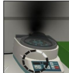
Abb. 4: Unwucht in einer Zentrifuge.
