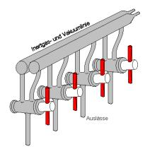
Inertgasüberdruck gesetzt werden können. Das ermöglicht zum Beispiel das Umfüllen von Flüssigkeiten, ohne dass diese dabei Kontakt mit der Luft haben. Die damit verbundene Spritzen-/Septentechnik zählt zu den fortgeschrittenen Labortechniken und ist in einschlägigen Lehrbüchern beschrieben. Sie ist nicht Gegenstand dieser Einführungshinweise.
