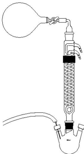
Versuchen Sie, durch das Größenwachstum des Ballons ein Gefühl dafür zu bekommen, wie schnell das Gas in die Apparatur einströmt.
