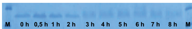
Abb. 5. SDS-PAGE, Spaltung von Myoglobin durch 0,5 mM \text{Co}^{\text{III}} -1-Hexadecyl-Cyclen. 0 – 8 h Inkubation bei 50 °C und pH 9 (Tris/HCl-Puffer, 50 mM). M = Marker.
