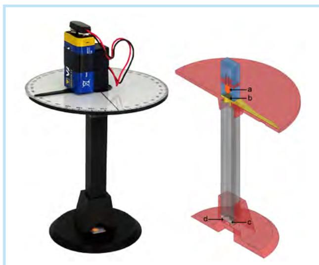
Abb. 5. Polarimeter aus dem 3D-Drucker. Links: Fotografie. Rechts: Schnittdarstellung. a) LED, b) Polarisationsfilter, c) Mikroskop-Deckgläschen, d) Polarisationsfilter
