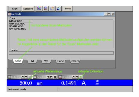
Im Praktikum werden nur die Scan-Methoden verwendet. "SCAN1.MSC" und "UVREPT3.MSC" sind mit der Software ausgelieferte Methoden. Für das Praktikum sind folgende Methoden adaptiert:
